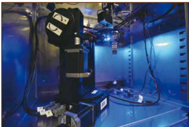
本港首台機械機芯和電子/石英機芯的天文台表測試設備，利用GPS連接人造衛星的原子鐘，參照世界標準時間，確保手表的準確性。
